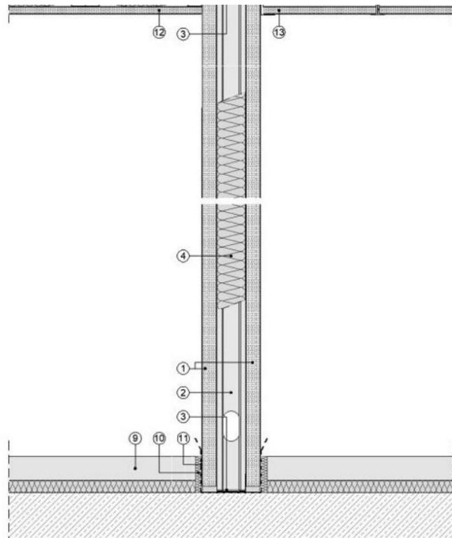
**Medianeras** entre viviendas, se realizará con ladrillo perforado de 11 cm trasdosado por ambas caras y aislamiento acústico sobre perfilería con panel de yeso laminado tipo Pladur o similar.
