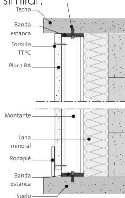
La separación de las viviendas **con escalera y elementos comunes**, se realizará mediante pared de ladrillo perforado acústico de 11 cm de espesor, enlucido de yeso en la cara de la escalera y trasdosado interiormente sobre perfilería con panel de yeso laminado tipo Pladur o similar.
