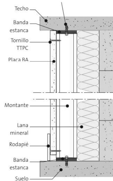
La separación de las viviendas **en escalera y elementos comunes**, se realizará mediante pared de ladrillo perforado acústico de 11 cm de espesor, enlucido de yeso en la cara de la escalera y trasdosado interiormente sobre perfilería con panel de yeso laminado tipo Pladur o similar.
